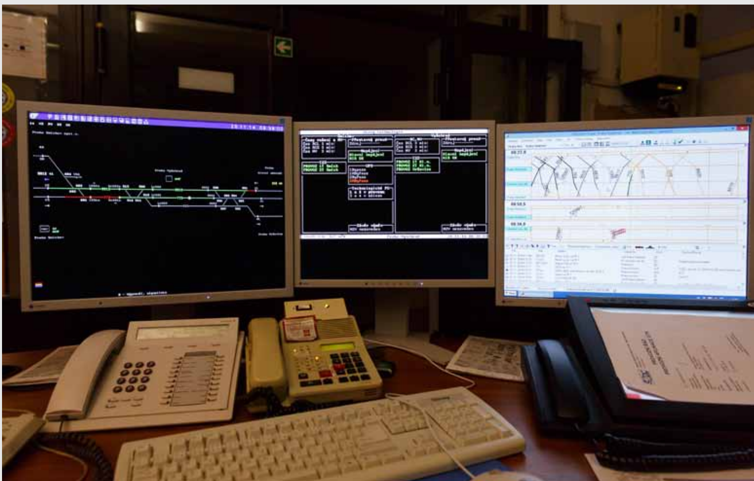
Automatické vkládání čísel vlaků z aplikace GTN do SZZ ESA Praha-Vyšehrad
