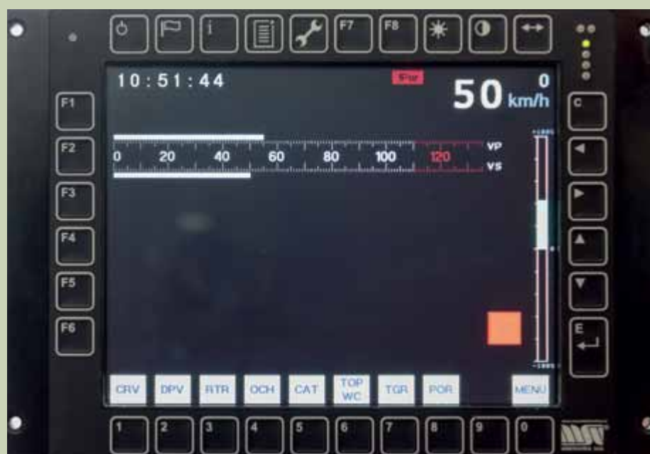
Návrh podoby indikátoru zobrazení blížícího se zásahu nouzové brzdy, pokud nedojde ke snížení rychlosti jízdy vozidla
