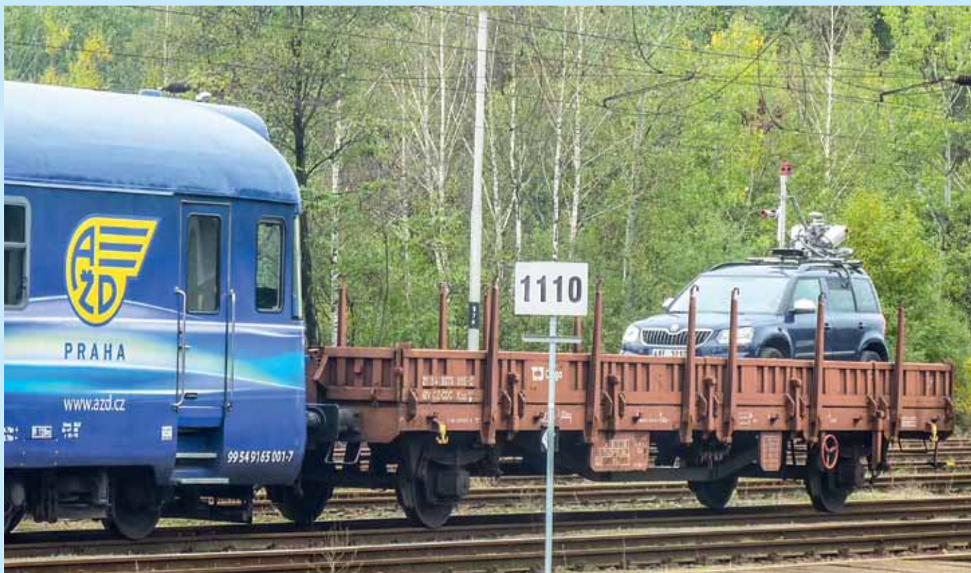
Obr. 6 Skenování tratě laserovým skenerem na střeše speciálního měřicího vozu
