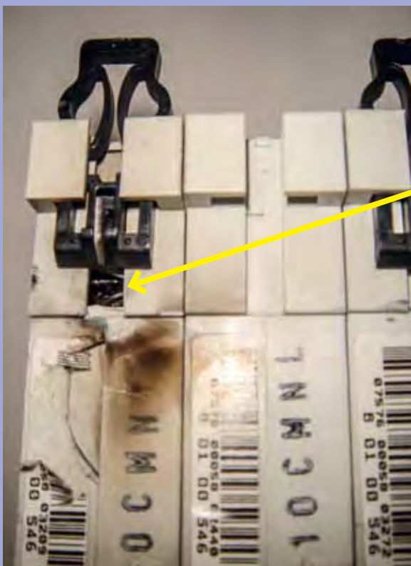
Místo přeskožení bleskového výboje (vniklého do kabelu) přes jistič na DIN-lištu a do země
