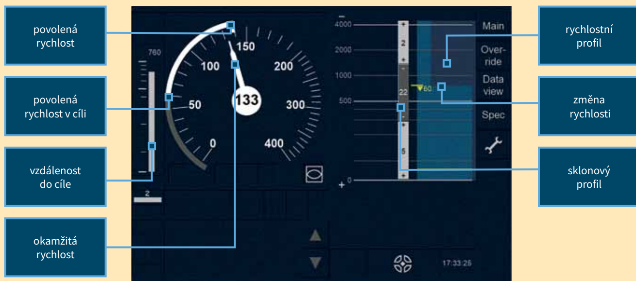
↑ Obr. 2 Příklad zobrazení informací o blížícím se cíli (snížení rychlosti na 60 \text{ km.h}^{-1} ) na displeji pro strojvedoucího DMI [zdroj: ERA. ERTMS/ETCS Driver-Machine Interface. Ref. ERA_ERTMS_015560 v3.6.0]
