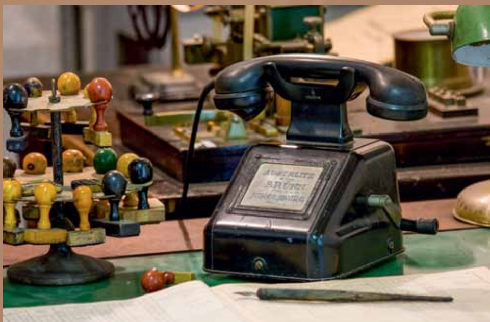
↓ Telefonní přístroj MB typ Ob 33 se používal na ČSD velmi dlouho
