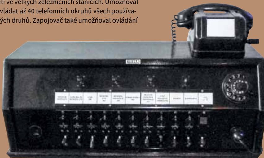
↓ 10-klapkový zapojovač AIDA
