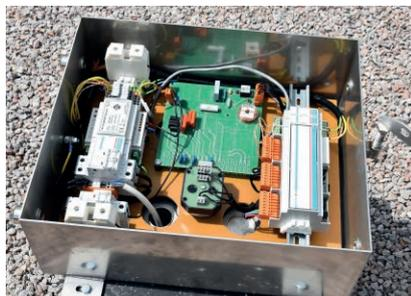
Выход детектора DELOK может быть подключен к устройствам СЦБ (например StationSWing ESA-44), которое не позволит подвижному составу двигаться на участке, на котором обнаружен излом рельса, или обеспечит ограниченную скорость движения на этом участке.
