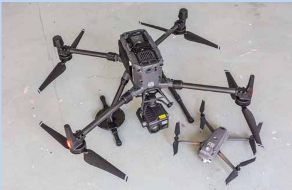
← DJI Matrice 300 RTK se senzorem H20T (20x Zoom 4K kamera + Wide Full HD kamera + Termokamera + Laserový dálkoměr) s malým dronem DJI Mavic 2 Enterprise ZOOM
