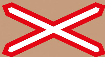
Výstražný kříž pro železniční přejezd jednokolejný
