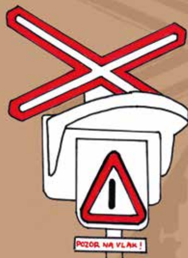
↑ Výstražník VÚD se sklopenou výstražnou značkou při poruše
