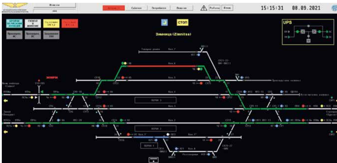
↑ Schéma kolejí stanic Zimnitsa na obrazovce Jednot- ného obslužného pracoviště
