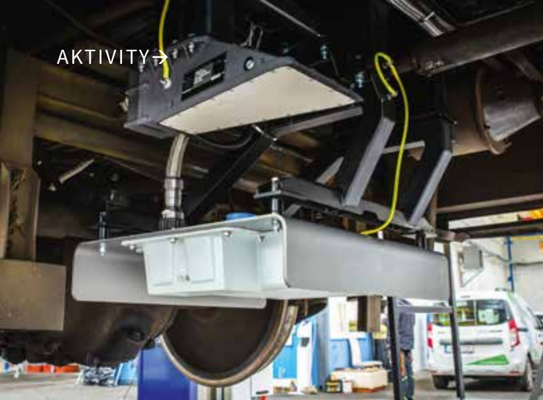
← Dopplerův radar (nahore) a BTM anténa (dole)
