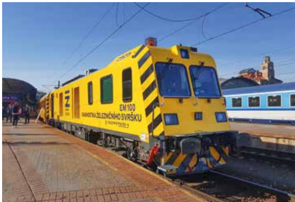
← Měřicí a diagnostický vůz Správy železnic EM 100, který je nově vybaven mobilní částí ETCS
