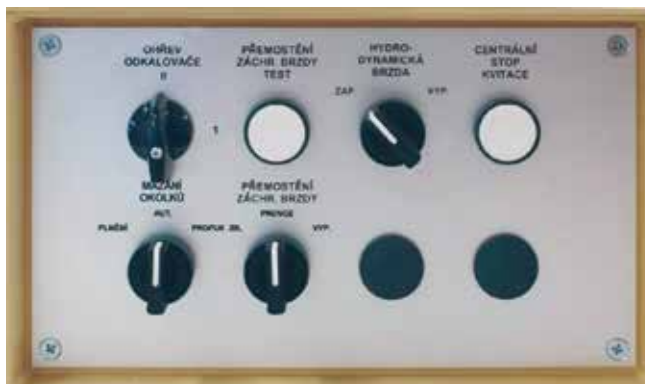
→ Příklad ovládání Přemostění záchranné brzd u jedné z aplikací MSV Elektronika
