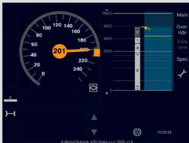
2b) ETCS informuje strojvedoucího, že překračuje dovolenou rychlost
