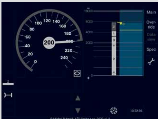
2a) ETCS zobrazuje strojvedoucímu dovolenou (na pozadí bezpečně dohlíženou) rychlost
