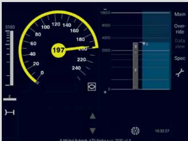
2e) ETCS přešlo do dohledu cíle a začalo strojvedoucího vyzývat ke snižování rychlosti (žlutou barvou) + zobrazovat mu informace o tomto cíli (v tomto případě k místu, kde končí oprávnění k jízdě, tedy 0 km/h za 3 100 m)
