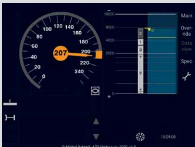
2c) ETCS – kromě varování optického (oranžovou barvou) – již varuje strojvedoucího také akusticky, že překračuje dovolenou rychlost a že se blíží k rychlosti zásahové
