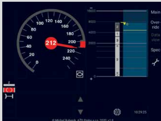
2d) ETCS již zavedlo brzdění a informuje o tom strojvedoucího (viz červenou barvou + červený symbol brzdy v levé dolní části displeje)
