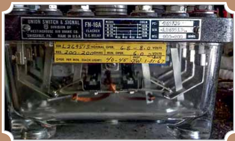
↓ Detail kontaktního systému klasického relé pro zabezpečovací techniku
