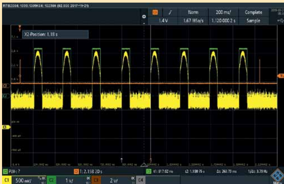
← Obr. 13 Osciloskopický záznam přijímaných dat z balíz
