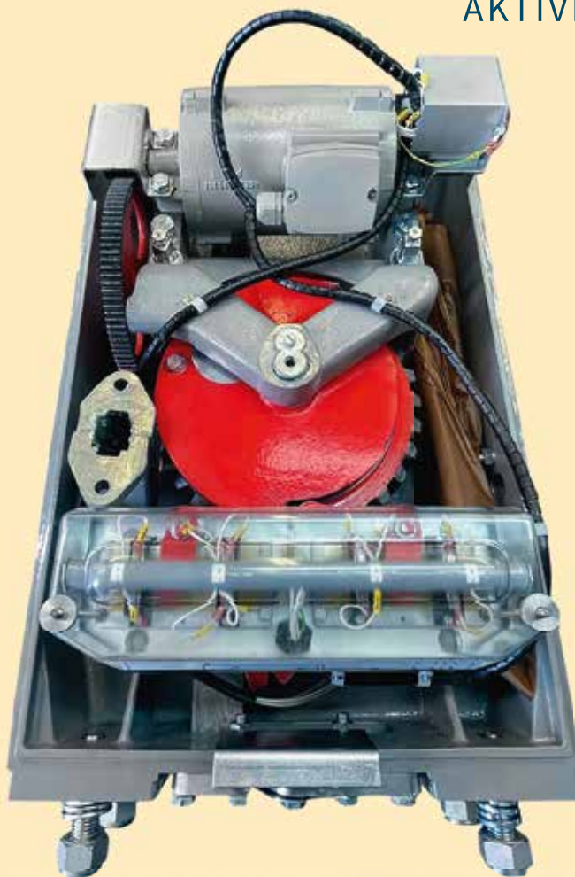
↑ Elektromotorický přestavník PointSWing EP-642
