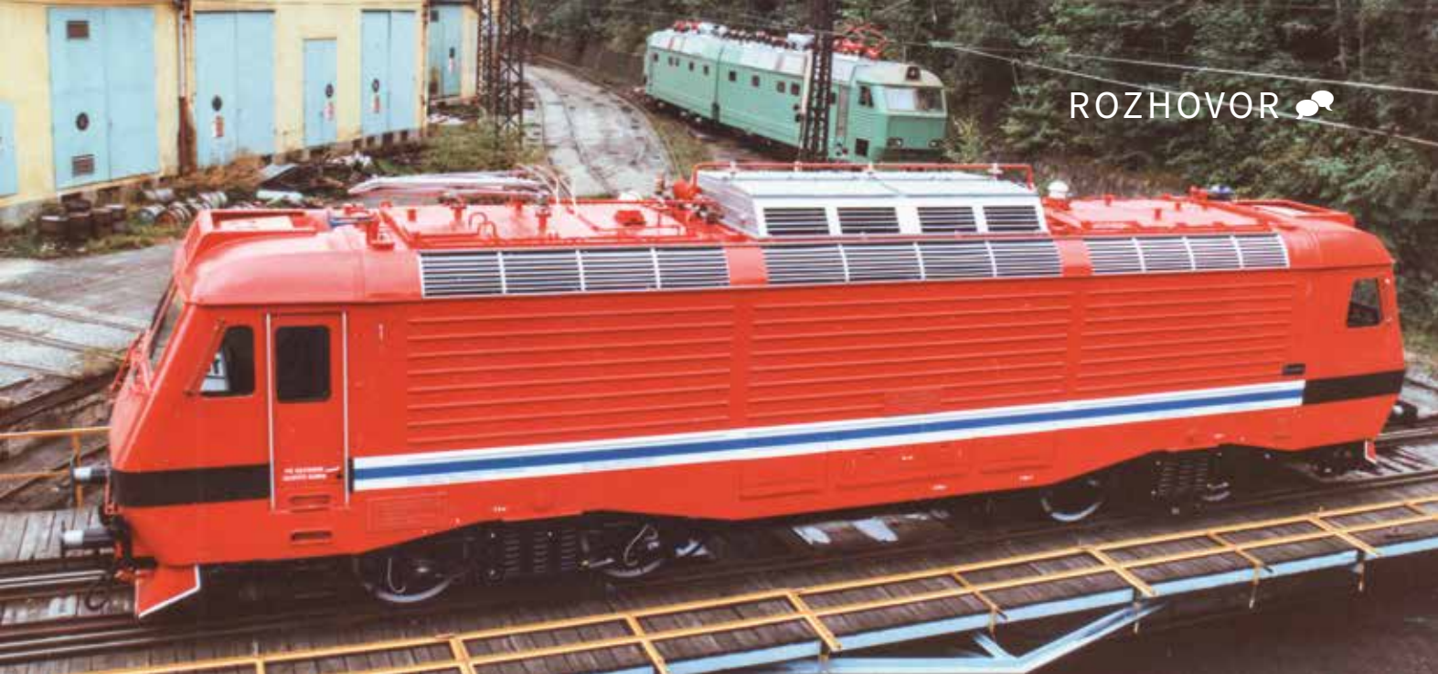
↑ Asynchronní lokomotiva řady 169 v plzeňském závodě Škoda po vyrobení v roce 1987
