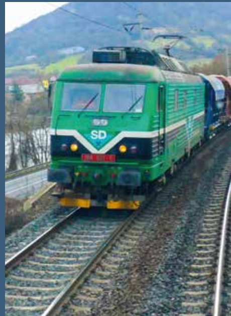
↑ Z konstrukční dílny Františka Palíky pochází i „šestikolák“ řady 184.5 vybavený třemi podvozky v uspořádání dvojkolí Bo' Bo' Bo'
