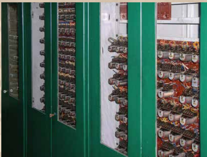
↓ Skříň s kódovými relé
