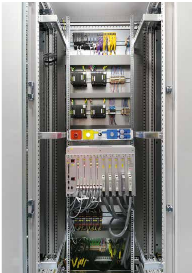
↓ Vyhodnocovací jednotka kolejových obvodů
