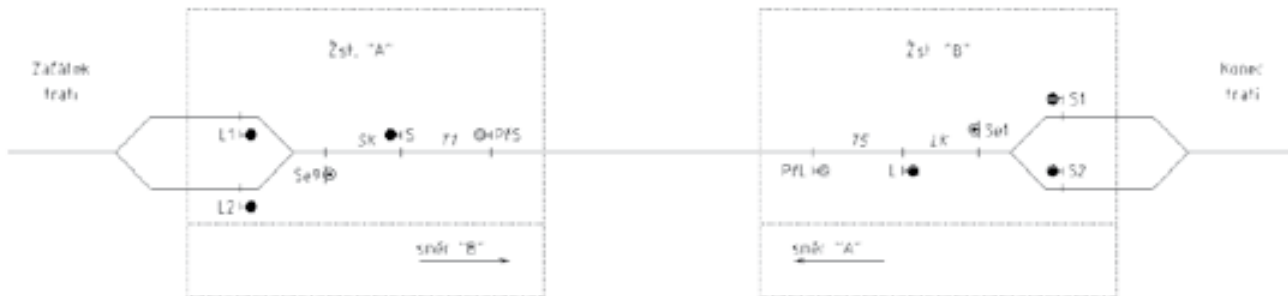
Blokové schéma AHP-03 pro traťový úsek bez hradla
