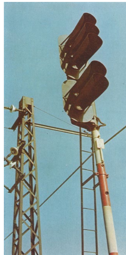
Světelné vjezdové návěstidlo
