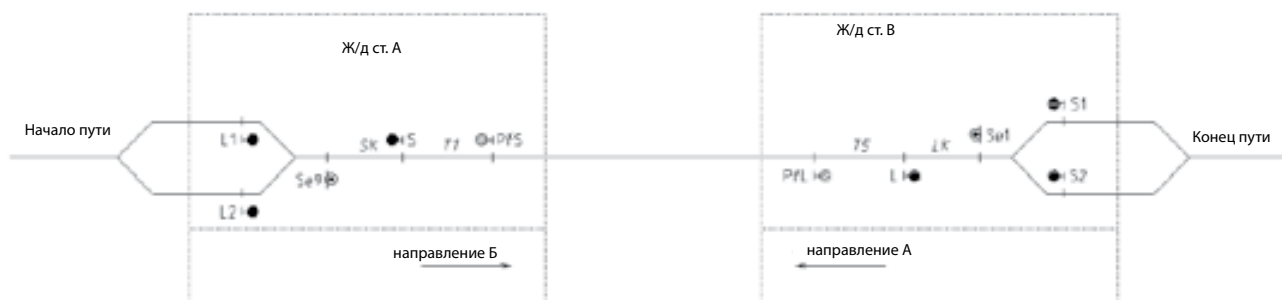
Блочная схема АНР-03 для путевого участка без блокпоста
