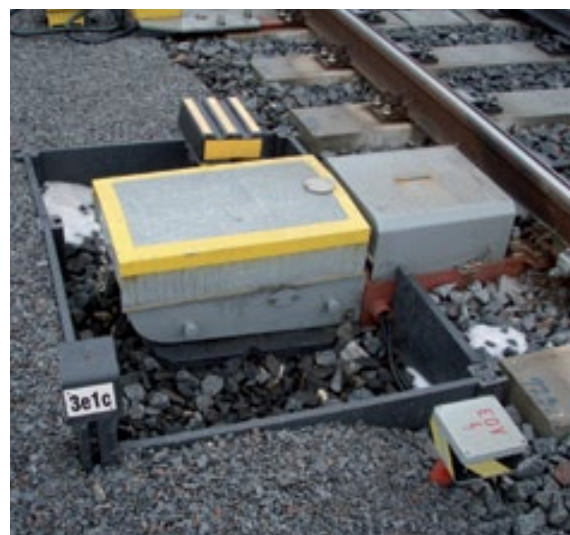
Фланцевое прикрепление электропривода
