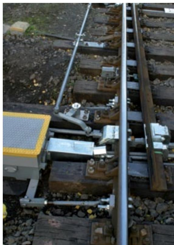
Шкаф электропривода к комплекту прикрепляется двумя передвижными крепежными скобами, которые являются составной частью электропривода EP 600. Соединение между зажимной доской и штырем тяги сделано обособленно.
