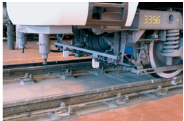
Датчики информации для мобильной части ATP
