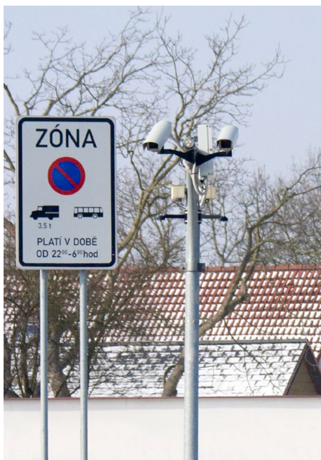
Опора с CCD камерами и инфракрасными прожекторами
