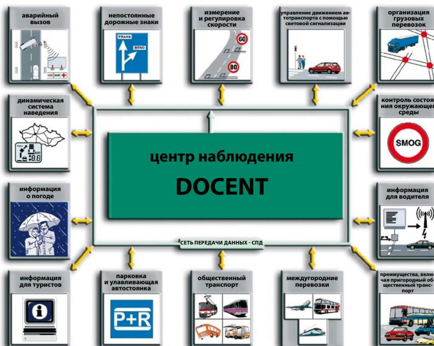
Схема возможного функционального использования центра контроля
