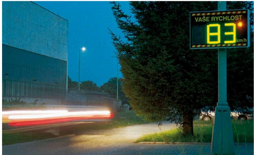
рования микроволнового радара с информационным дисплеем. Система оснащена электромагнитическими точками с LED диодной подсветкой или LCD дисплеем, или сильно светящимися LED диодами.
