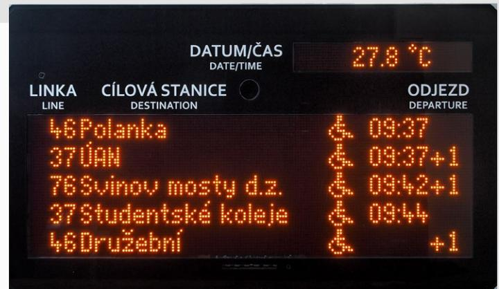
Электронная светодиодная панель для остановок предназначена для изображения информации для пассажиров на трамвайных, автобусных, троллейбусных остановках и железнодорожных станциях. Буквенно-цифровым текстом и простыми графическими символами она предоставляет пассажирам, прежде всего, информацию о маршруте, направлении, времени и типе транспортного средства. Может изображать также важные сообщения об актуальных изменениях в движении транспорта, например
