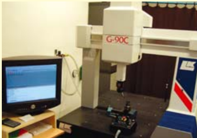
Digitální měřicí centrum, které umožňuje kontrolu kvality výrobků s vysokou přesností.
