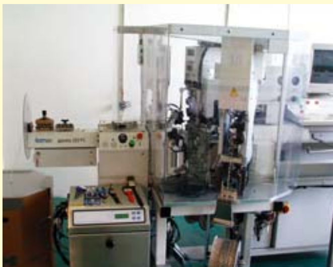
Automat KOMAX 333 PC – zařízení na výrobu vodičových svazků pro Whirlpool.
