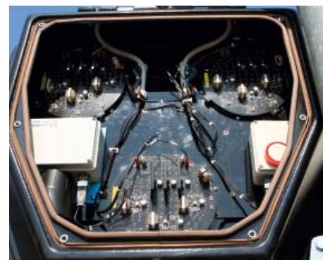
Pohled na vnitřní část výstražníku vybaveného LED světly
