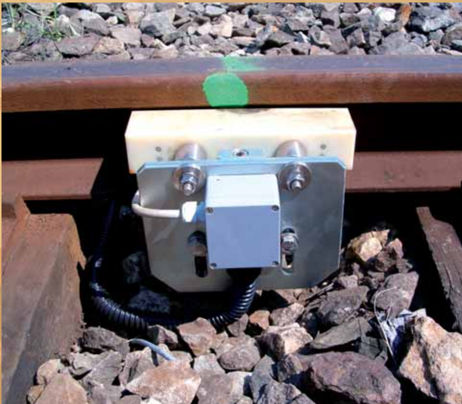
Čidlo, které odhalí nedovolené projetí návěstidla
