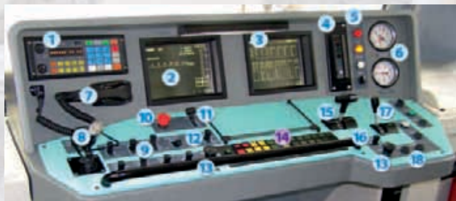
Panel elektrické jednotky řady 471 – 1: ovládací skříňka radiostanice; 2 displej vozového počítače (provozní údaje); 3 displej vozového počítače (diagnostické údaje); 4 návěstní opakovací; 5 kontrolky (požár, dveře, zastávka na znamení), ovládání osvětlení přístrojů; 6 tlakoměry brzd; 7 mikrotelefon radiostanice; 8 mikrofón vlakového rozhlasu; 9 ovladače vozových zařízení (stěrače, informační systém, kompresory, osvětlení apod.); 10 tlačítko hlavního vypínače; 11 volič směru; 12 ovladač sběračů; 13 tlačítka bdělosti; 14 klávesnice Automatického vedení vlaku; 15 hlavní jízdní páka (ovládání výkonu, elektrodynamické brzdy a pneumatické brzdy); 16 ovladač dveří; 17 ovladač přidavné brzdy; 18 tlačítka houkaček, pískování a závěru brzd
