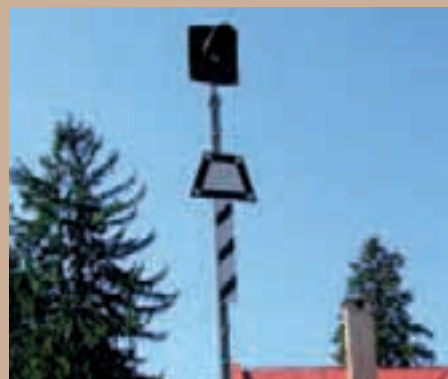
Lichoběžníková tabule se žlutým světlem před dopravnou se samovratnými výhybkami v Banské Štiavnici
