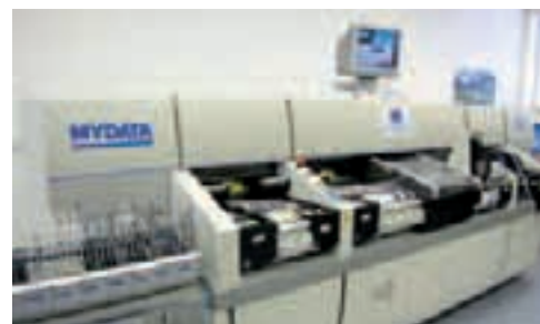
34 • OSAZOVACÍ AUTOMAT MYDATA MY15. OSAZOVÁNÍ JE ŘÍZENO POČÍTAČEM S VÍCEÚLOHOVÝM, VÍCEUŽIVATELSKÝM, VÍCEVÝROBKOVÝM OPERAČNÍM SYSTÉMEM – TECHNOLOGIE VÝROBY ELEKTRONICKÝCH SESTAV
