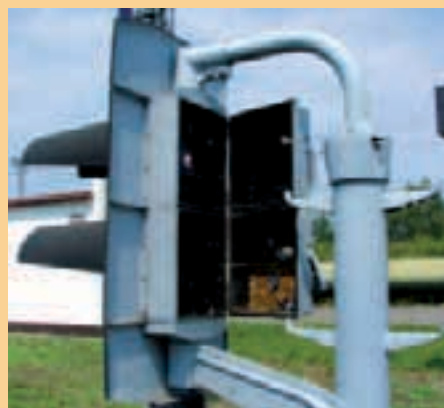
Vnitřek návěstidla AŽD 70 v Muzeu sdělovací a zabezpečovací techniky v Hradci Králové
