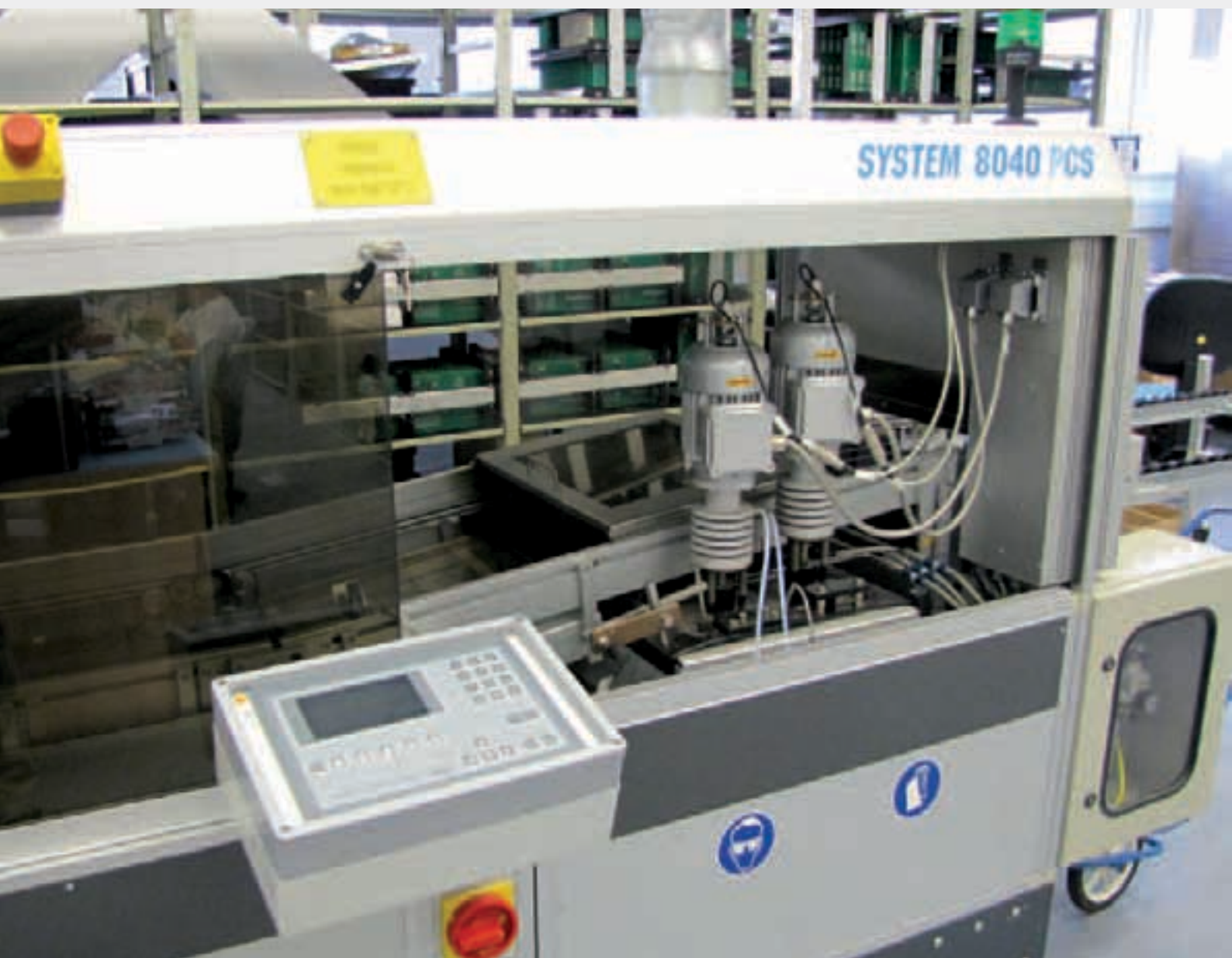
Zařízení pro pájení vlnou SEHO 8040-PCS – pájecí nádoba s čerpadly
