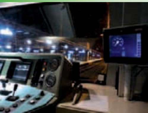
Ovládací panel ETCS (DMI) na stanovišti strojvedoucího jednotky řady 471 (dotyková obrazovka vlevo)
