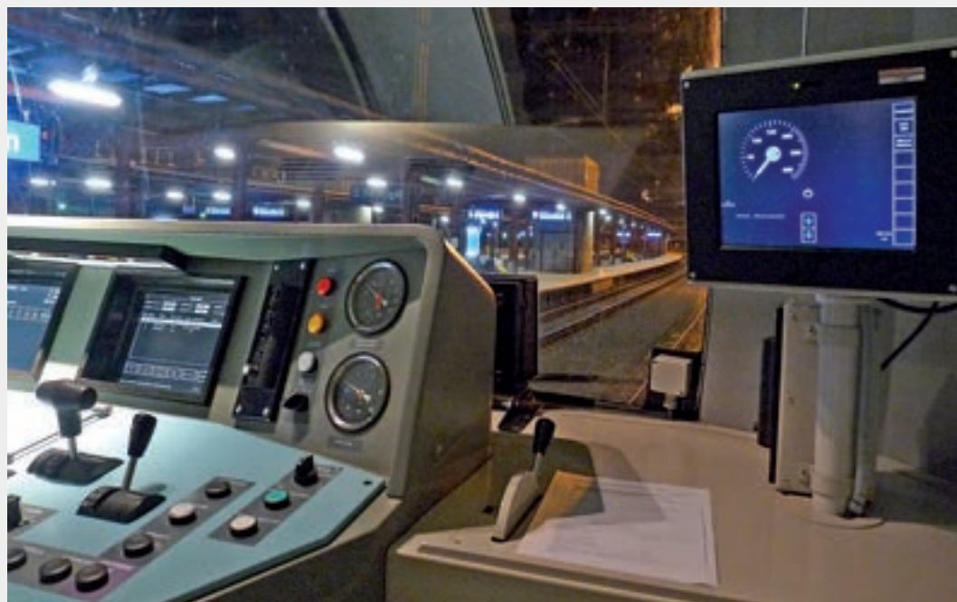
Taťové zkoušky ETCS s jednotkou 471.042
