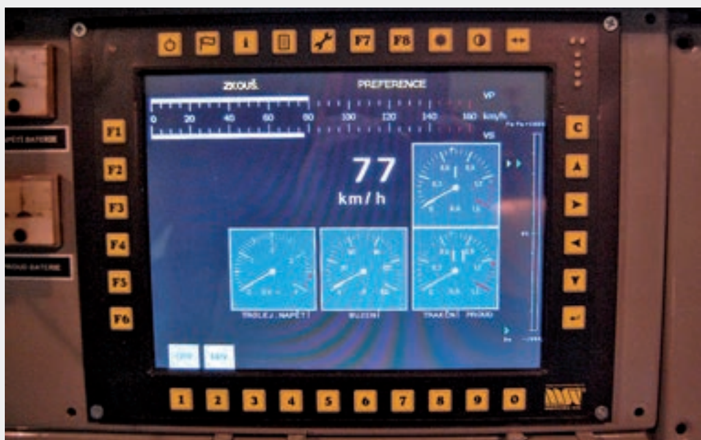
Zobrazení na displeji strojvedoucího na lokomotivě 362.166 – provoz v režimu Automatické regulace rychlosti
