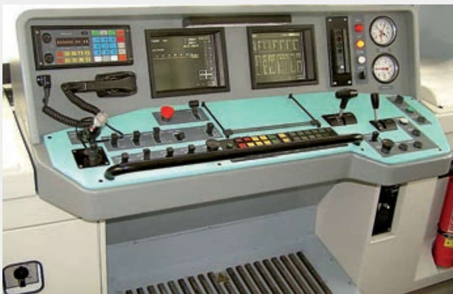
Pult strojvedoucího na elektrické jednotce řady 471, standardně vybavené systémem AVV
