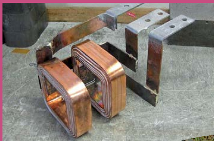
1) Ze dvou navinutých cívek (polovin hlavního vinutí) a z připravených vývodů hlavního vinutí je technologií tvrdého pájení vyroben svařenec hlavního vinutí.
