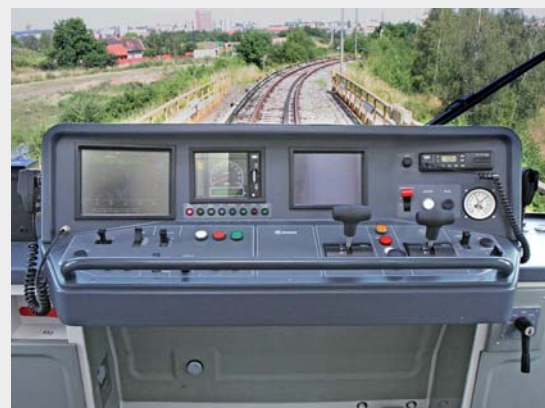
Pult strojvedoucího při zkouškách mobilní části LZA
