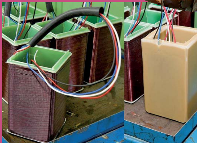
3) Doplňující vinutí je navíjeno strojně z lakovaného vodiče o průměru 0,9 mm na laminátovou kostru (vlevo) a poté je ve formě zalito polyuretanovou zalévací hmotou, čímž vznikne izolovaný kompaktní celek zaručující elektrickou pevnost mezi hlavním a doplňujícím vinutím 4 kV.
