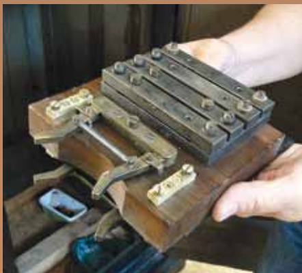
Hrubé jiskřiště a část kontaktního systému distančního návěstidla
