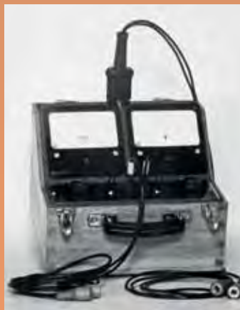
Jednouúčelové měřicí přístroje: Fázoměr FM 2 pro kontrolu kolejových obvodů s přijímačem DSR-1 nebo DSR-12 patřil do výbavy laboratoří. Vpravo zkušební a měřicí přístroj pro polarizovaná relé Trls 43a a selektory T 53 (foto PKVP-SZ/VÚŽ)
