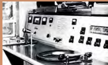
Pro záměr zvýšit úroveň cestování měl na přelomu 50. a 60. let 20. století napomoci vlakový rozhlas. Zařízení, zabudované do jednoho kupé, vyžadovalo specializovanou údržbu i opravy, která se soustředila do depa v Praze
