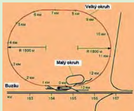
Obr. 9 Kolejové schéma výzkumné základny u města Buzău v Rumunsku
