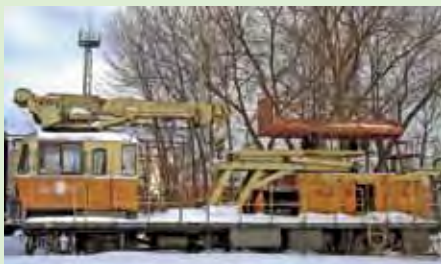
Obr. 6 Motorový vůz pro opravy a údržbu trakčního vedení okruhů a pomocných kolejí s izolovanou pracovní plošinou
