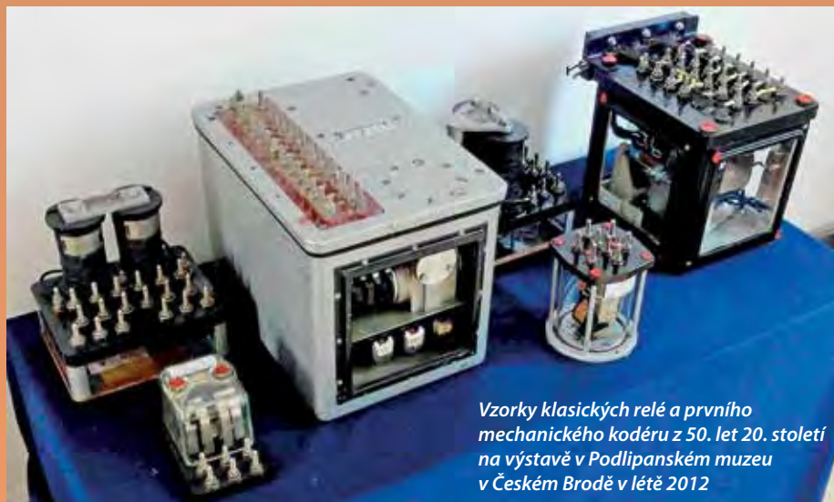
První automatické bloky a staniční reléová zabezpečovací zařízení (od 1953) používaly tzv. klasická elektromagnetická relé různých typů. Nástrčkové desky na dílky kontaktů (M6) se uplatnily skoro o deset roků později (na obr. sovětský typ relé NPR 4 a NPR 6 československé provenience)
