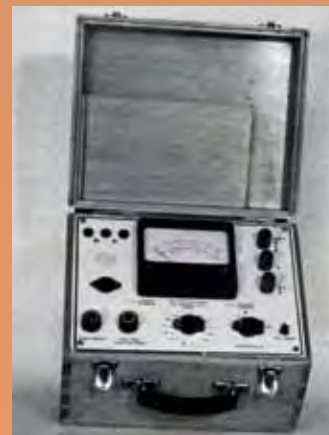
Jednouúčelové měřicí přístroje: Fázoměr FM 2 pro kontrolu kolejových obvodů s přijímačem DSR-1 nebo DSR-12 patřil do výbavy laboratoří. Vpravo zkušební a měřicí přístroj pro polarizovaná relé Trls 43a a selektory T 53 (foto PKVP-SZ/VÚŽ)
