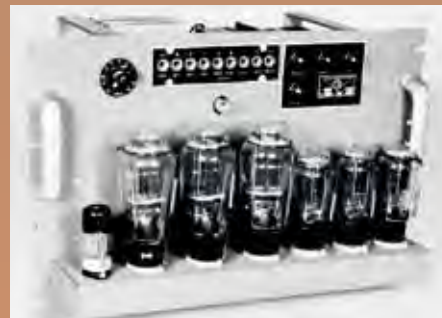
V 50. letech 20. století si podniky ČSD vyráběly také zesilovače pro staniční rozhlas (na obr. nř zesilovač Z 72)
