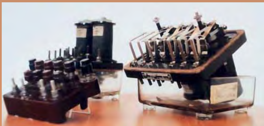
První automatické bloky a staniční reléová zabezpečovací zařízení (od 1953) používaly tzv. klasická elektromagnetická relé různých typů. Nástrčkové desky na dílky kontaktů (M6) se uplatnily skoro o deset roků později (na obr. sovětský typ relé NPR 4 a NPR 6 československé provenience)
