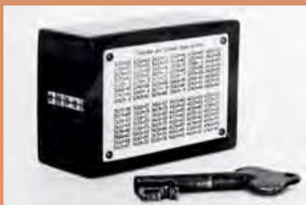
Jednoduchý přístroj pro kontrolu klíčů výměnových zámků (ČSD – Výroba sdělovacích a zabezpečovacích zařízení a nást. org.)
