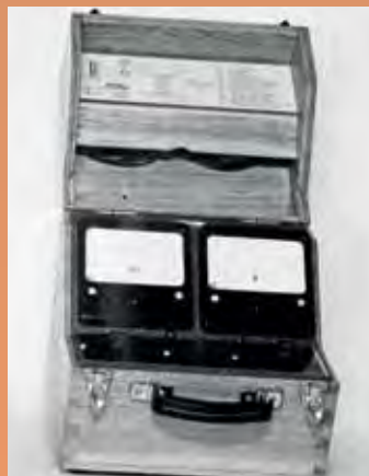
Jednouúčelové měřicí přístroje: Fázoměr FM 2 pro kontrolu kolejových obvodů s přijímačem DSR-1 nebo DSR-12 patřil do výbavy laboratoří. Vpravo zkušební a měřicí přístroj pro polarizovaná relé Trls 43a a selektory T 53 (foto PKVP-SZ/VÚŽ)
