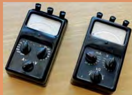
Univerzální měřící přístroje typu AVOMET I. (vlevo), II. nebo DU 10 (vpravo) svoji třídou přesnosti, vnitřním odporem a odolností dlouho sloužily při provozních měřeních včetně kolejových obvodů
