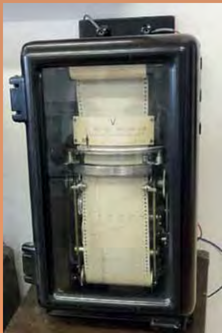
Registrační analogové měřicí přístroje napětí a proudu z poloviny 20. století byly dlouho nenahraditelné (sbírka v MESZT v Hradci Králové)
