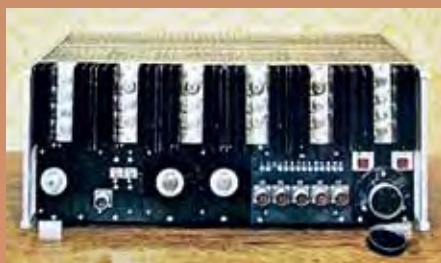
Měnič ZBZ 2-75/2 x 200 VA – zdroj proudu pro napájení kolejových obvodů o signálním kmitočtu 75 Hz (reprodukce z brožury „30 let AŽD“)
