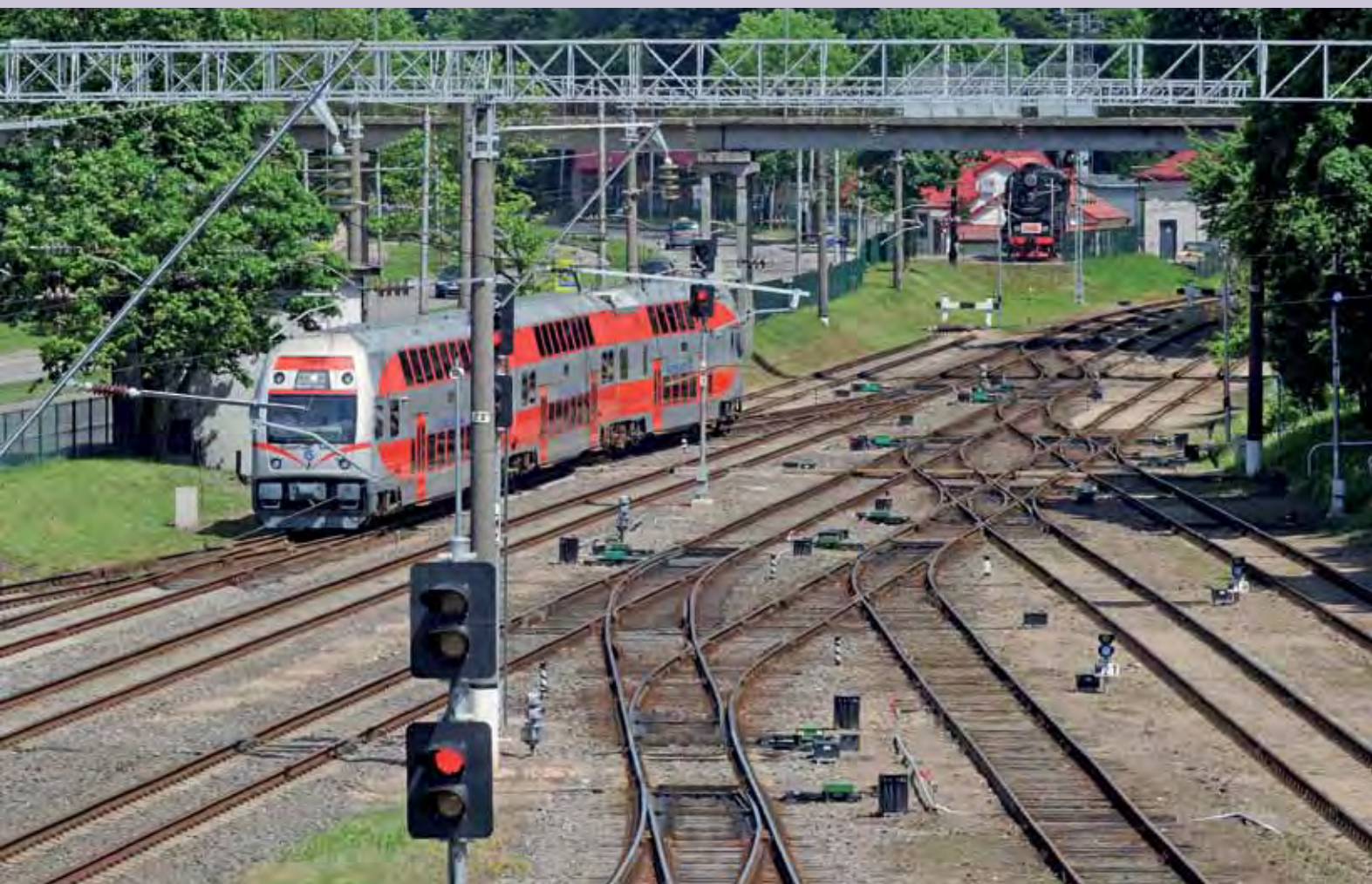
Vjezd do stanice Kaunas, všimněte si dvoupodlažní elektrické jednotky řady 575 Škody Transportation
