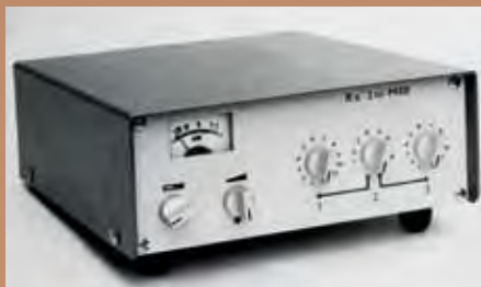
Počátky elektroniky u SZT: Elektronický kodér EK 1 a kontrolní přijímač VKV pro rádiový provoz na kmitočtech 150–160 MHz (ČSD – Sdělovací a zabezpečovací dílny Hradec Králové)
