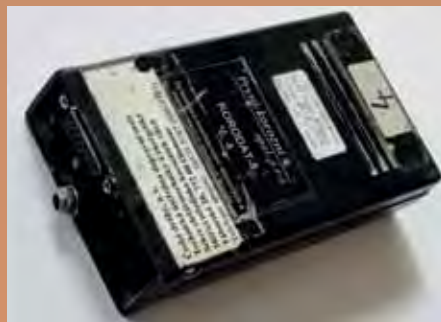
Proti krádeži raději nepřilíš vzhledná krabička KORODATU v libovolném časovém intervalu měří a uchovává ve své paměti hodnoty potenciálu úložného kovového zařízení nebo konstrukce proti normalizované referenční elektrodě (vlevo novější a vpravo původní verze z 90. let 20. století)
