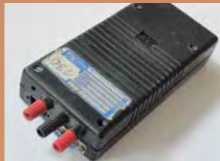
Proti krádeži raději nepřilíš vzhledná krabička KORODATU v libovolném časovém intervalu měří a uchovává ve své paměti hodnoty potenciálu úložného kovového zařízení nebo konstrukce proti normalizované referenční elektrodě (vlevo novější a vpravo původní verze z 90. let 20. století)
