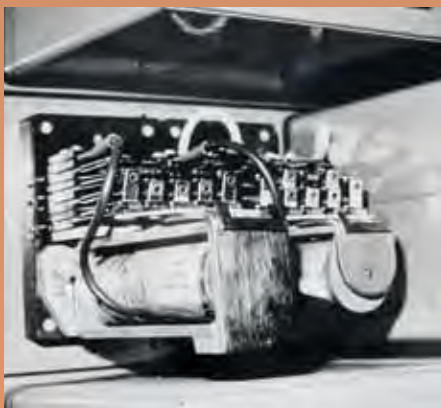
Jednotka volicí skupiny staničního reléového zabezpečovacího zařízení ze 70. let 20. století (kryt sejmut)
