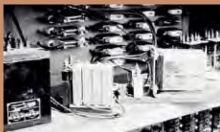
V 60. letech 20. století se v reléových skříních (typ ŠM) automatického bloku kromě klasických relé začala aplikovat také tzv. malorozměrová relé
