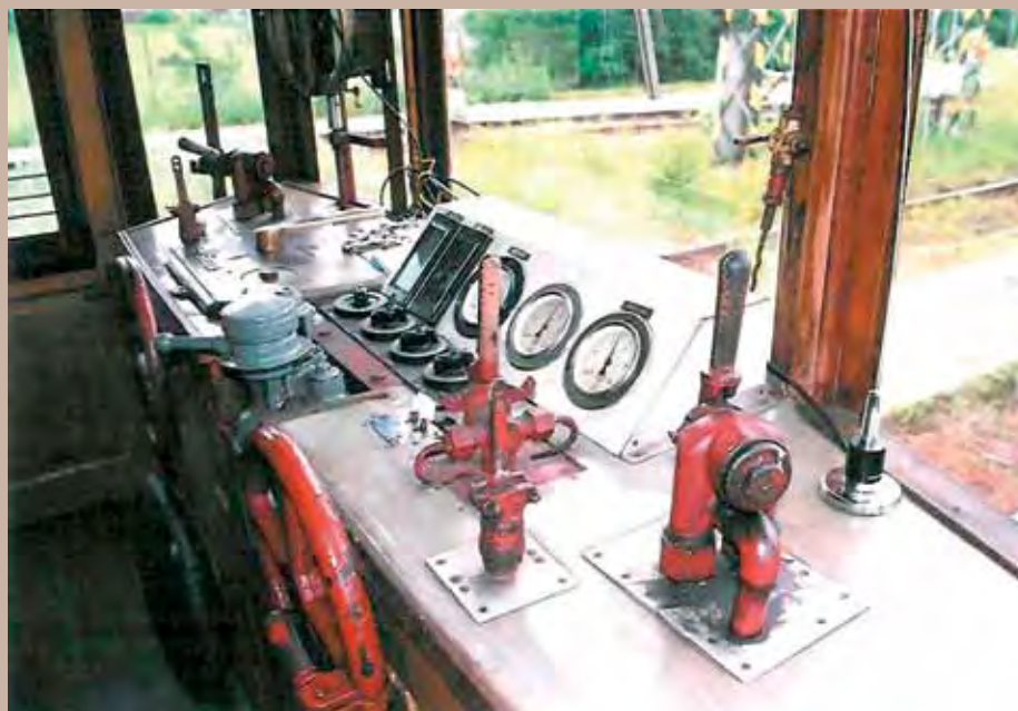
Stanoviště strojvedoucího Křižíkova vozu M 400.001 rekonstruované v ŽOS Vrutky
