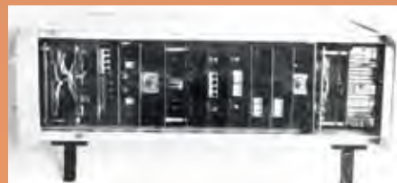
Vzorek multiplexního zařízení MUZA (bez čelního krytu) pro běžný a zabezpečený přenos diagnostických signálů v 8 kanálech po dvoudrátovém vedení nebo ve 4 kanálech po čtyřdrátovém vedení (foto VÚŽ Praha)
