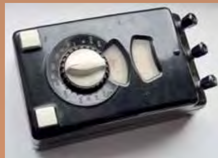
RLC 10 – tuzemské orientační měřidlo odporů, indukčností a kapacit ze 70. let 20. století
