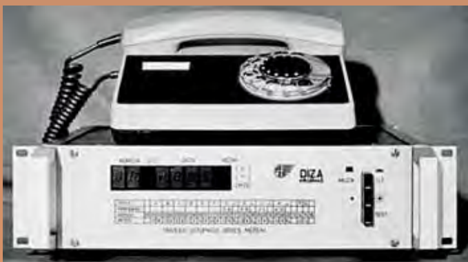
Přijímač diagnostických hodnot DIZA k multiplexnímu zařízení MUZA (foto AŽD)
