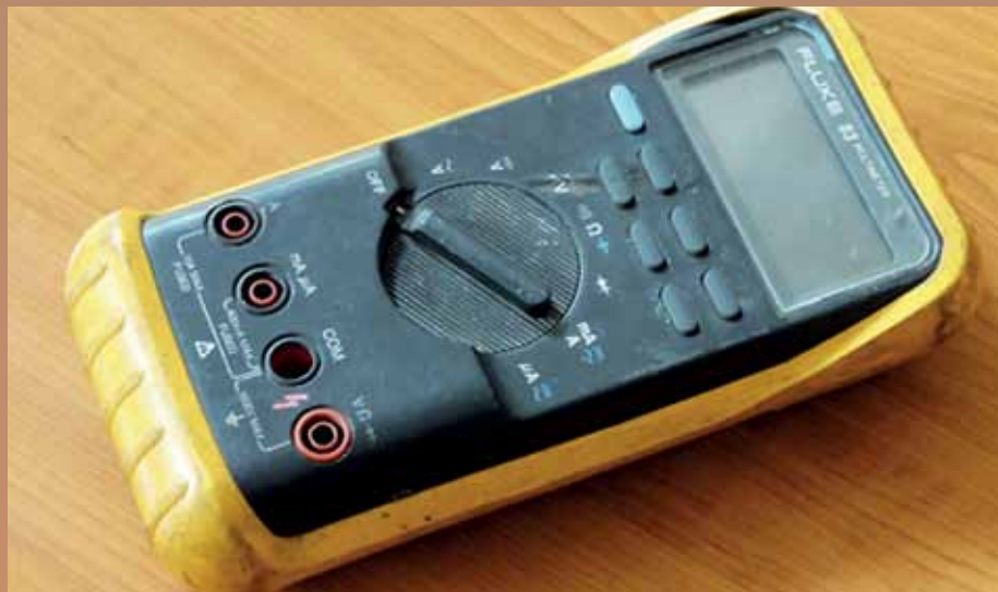
Jedno z prvních, pro údržbu schválených a zavedených, univerzálních digitálních měřidel elektrických veličin reprezentoval typ FLUKE 83
