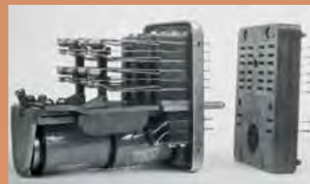
Jedno z prvních zástrčkových malorozměrových relé typu NMŠ s krytem a bez (z přelomu 50. a 60. let minulého století)
