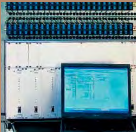
Diagnostika elektronického autobloku ABE-1 pomocí notebooku (reprodukce z prospektu společnosti AŽD Praha)
