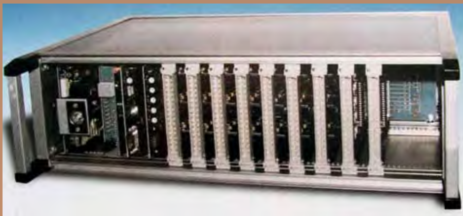
Měřicí ústředna k systému DIAB-2 pro snímání informací o traťovém nebo staničním zabezpečovacím zařízení (reprodukce z prospektu společnosti Starmon)
