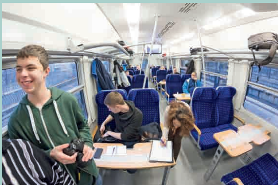
Oddíl pro cestující v přípojném voze, který je plně klimatizován. Na monitorech pod stropem lze sledovat jakékoli měření, ale i přímý přenos z kamery, která sleduje trať před jedoucím měřicím vozem
