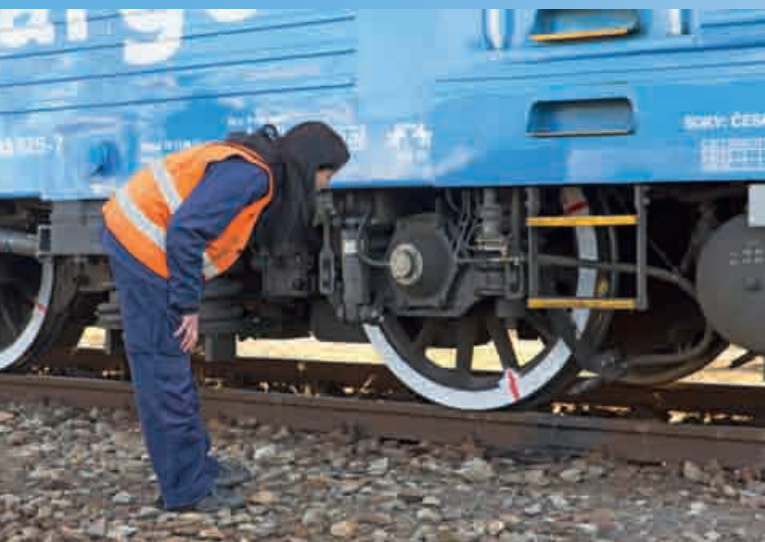
Nezbytná kontrola před jízdou. Prohlížím všechno na podvozku, kde by se mohla vyskytnout mechanická závada
