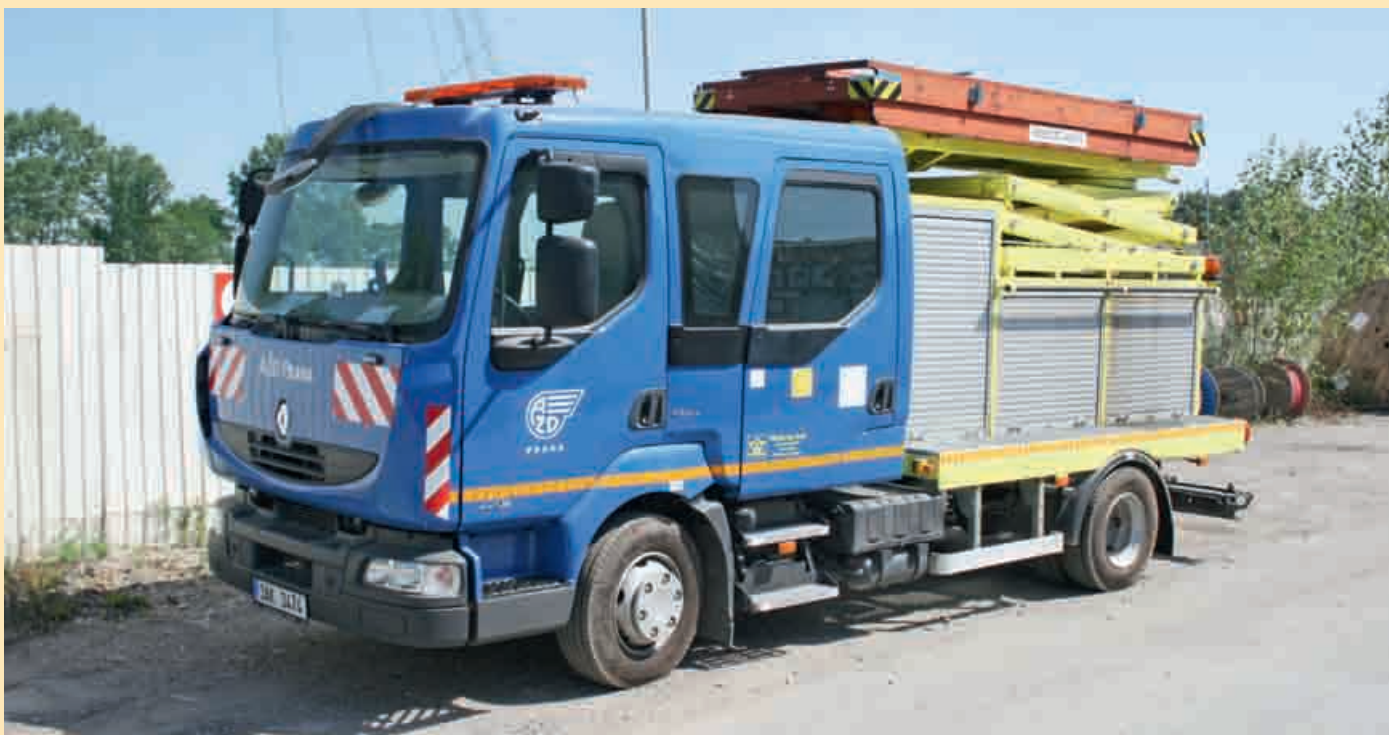
Montážní plošina pro výškové práce v tunelových troubkách
