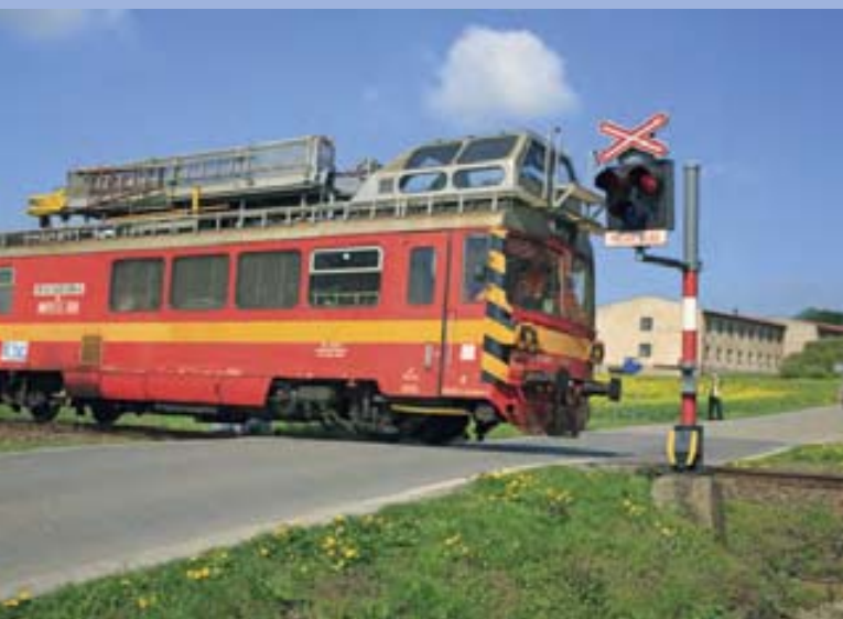
Ověřovací pokus začíná. Drážní drezína přijíždí k přejezdu rychlostí 62 km/h, přejezd jde do výstrahy
