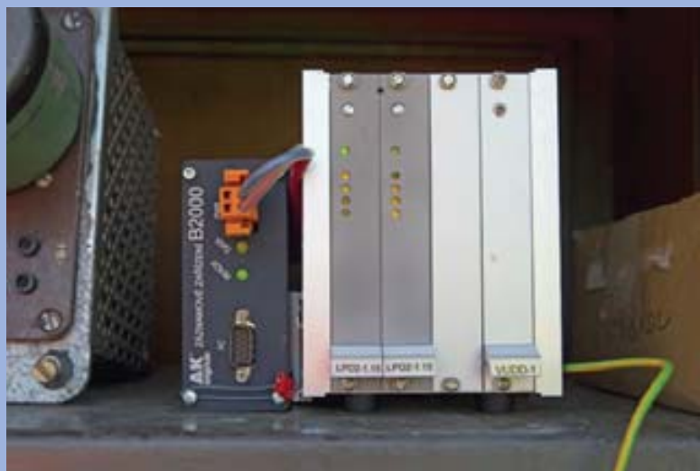
Záznamové zařízení čili jakási černá skříňka přejezdu P 5270
