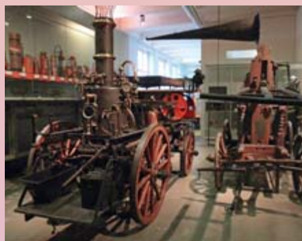
Vzadu je parní stříkačka typ 134, tlak vody byl až 11 atm. Vpředu je ruční stříkačka z roku cca 1750
