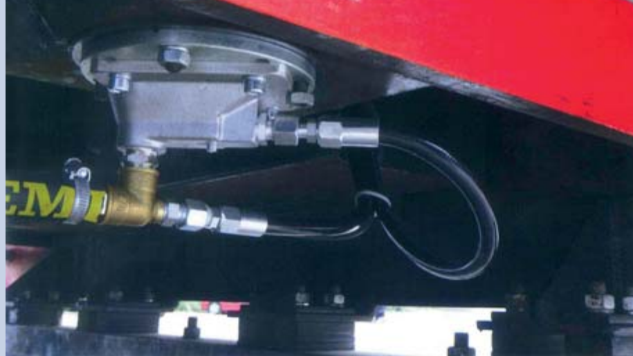
Vyhřívaný zásobník nového pískovacího zařízení
