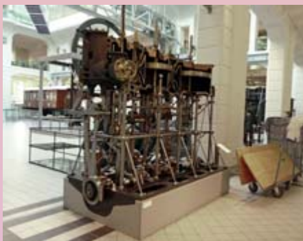
Parní stroj s trojnásobnou expanzí páry
