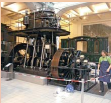
Sdružený parní stroj s dynamem s vnitřními póly
