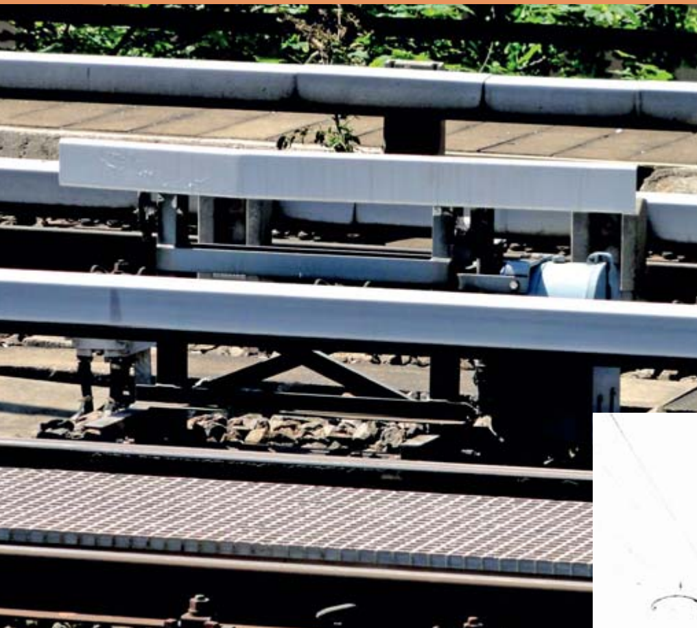
Mechanický snímač u návěstidla v poloze povolující jízdu a vlevo zakazující jízdu (žst Berlin – Am ZOO, S-Bahn, foto z června 2013)
