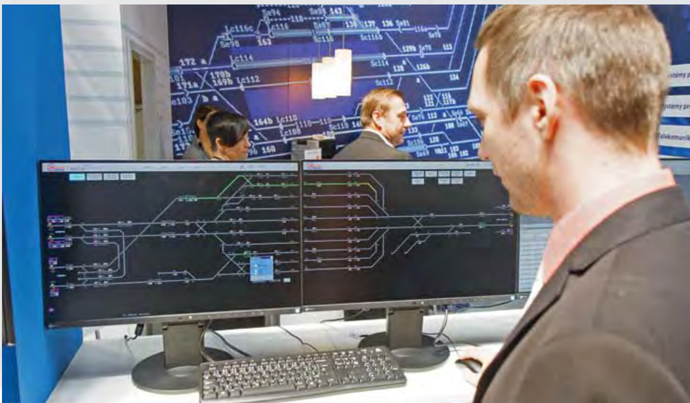
Simulace Jednotného obslužného pracoviště staničního zabezpečovacího zařízení ESA11-SB pro stanici Bělehrad-Centrum
