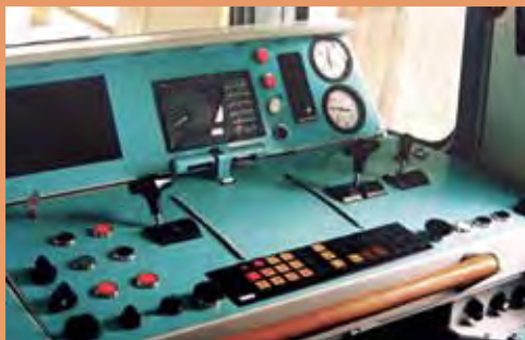
Jednotné stanoviště strojvedoucího (reprodukce z prospektu AŽD Praha)
