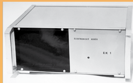
Původní elektromotorický kódér bez krytu a jeden z prvních elektronických kódérů – typ EK 1 vyrobený v ČSD – Sdělovacích a zabezpečovacích dílnách v Hradci Králové na počátku 80. let 20. století (sbírka autora)
