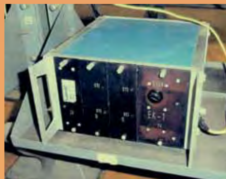
Normální adaptér pro případy, kdy kódování z napájecí strany kolejového obvodu nebylo možné, a první funkční vzorek elektronického kódérů EK-1 (foto ze sbírky Doc. Ing. Ivana Konečného, CSc.)
