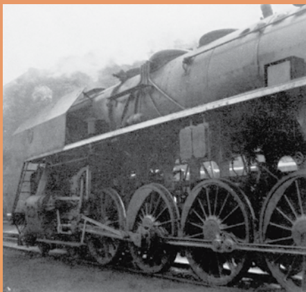
Prototypová přístrojová (nad koly) a bateriová skříň LVZ (na rámu) na ČSD 475.1133 (z přednášky Doc. Ing. Ivana Konečného, CSc. 21. 5. 2013)
