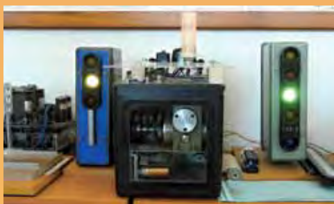
Funkční model československého LVZ z 60. let 20. století. Vlevo model autoblokového návěstidla, uprostřed mechanický kodér a vpravo návěstní opakovací LVZ (foto z června 2013)
