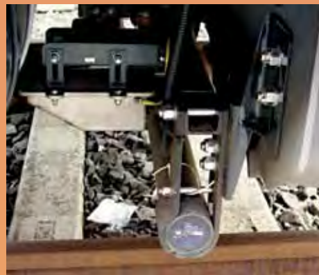
Lokomotiva 380 001-8 vybavená snímači LVZ typ MIREL SN a pro EUROBALÍZU (foto z května 2012)
