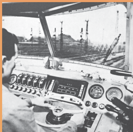
Stanoviště strojvedoucího s návěstním opakovacím LVZ firmy Siemens
