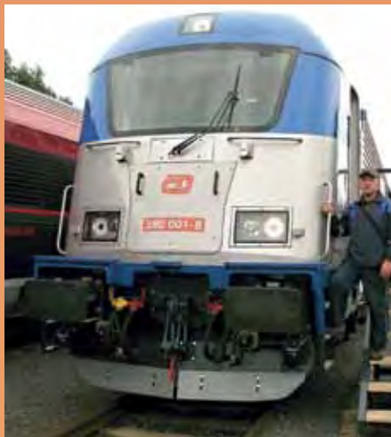
Lokomotiva 380 001-8 vybavená snímači LVZ typ MIREL SN a pro EUROBALÍZU (foto z května 2012)
