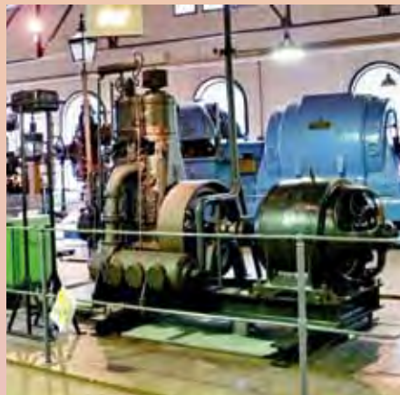
Napájecí soustrojí napěťové soustavy se sníženým kmitočtem, obvykle AC 15 kV 16,7 Hz
