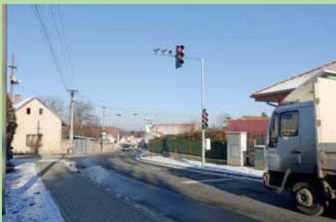
Jednosměrný systém SpeedStop před zvýrazněným přechodem a koncové kontrolní stanoviště systému měření úsekové rychlosti
