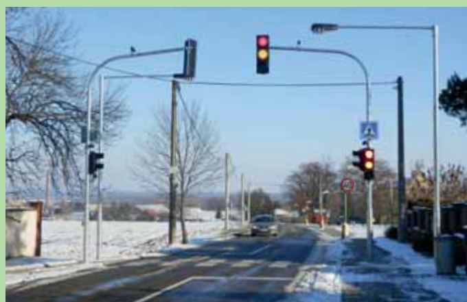
Světelně řízený poptávkový přechod s funkcí „zpomalovacího semaforu“ v ulici Školná (původní a současný stav)
