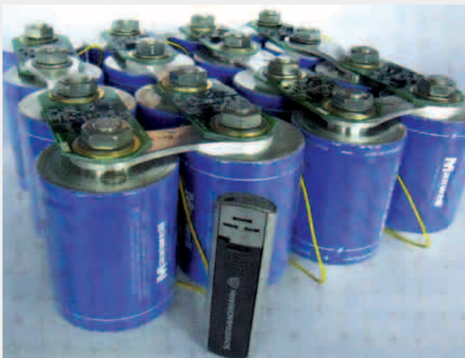
Obr. 3 Modulární uspořádání 16 superkapacitorů
