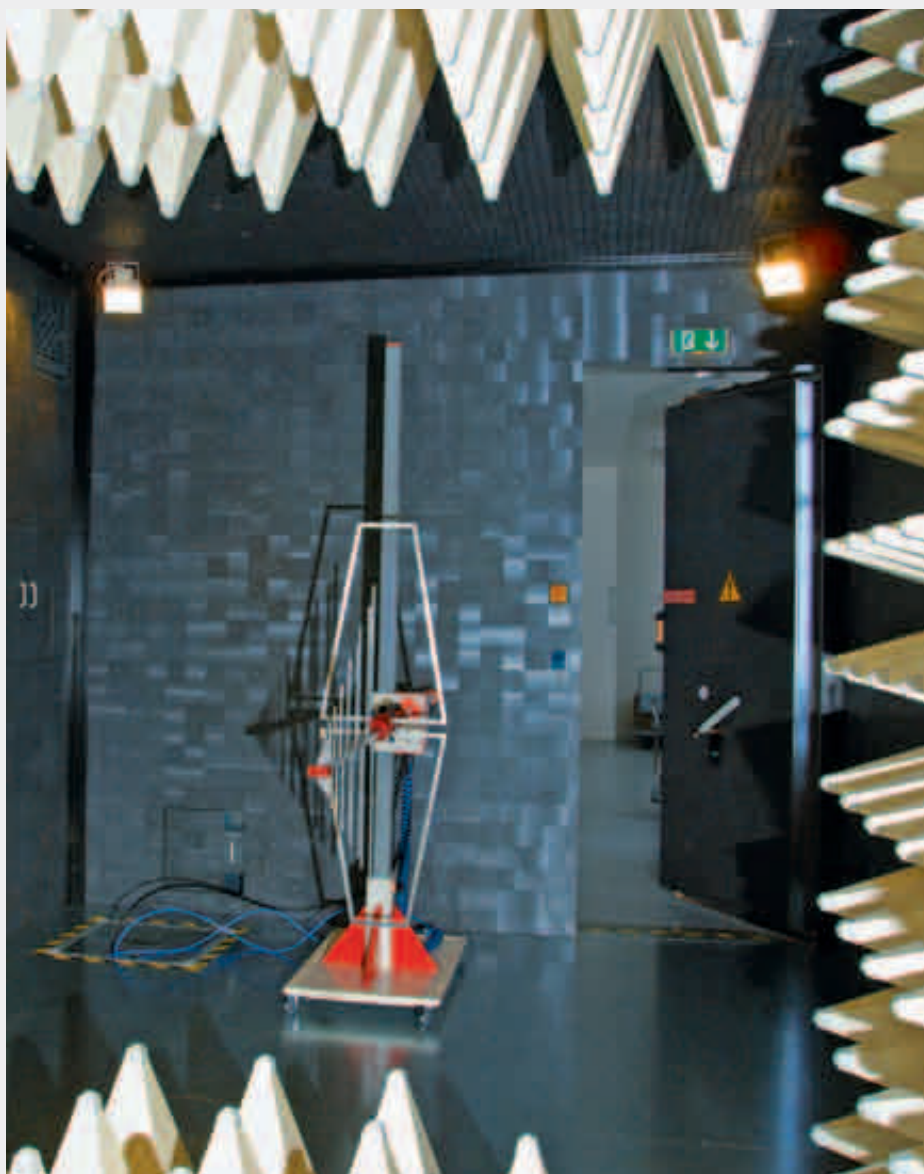
Interiér komory pro zkoušky elektromagnetické kompatibility. V pozadí je logaritmicko-periodická anténa
