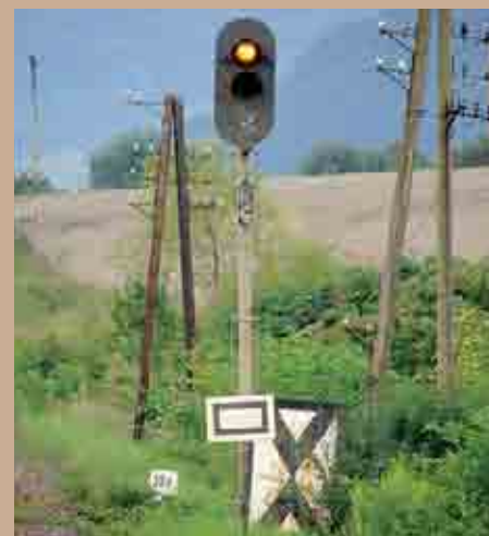
PrS žst. Hanušovce nad Topľou – předvěst se zaslepeným spodním světlem
